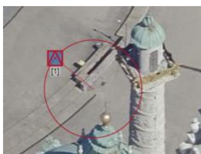
Abb. 12 Anzeige eines Messwiderspruchs anhand eines Fehlerkreises in MEASUREE
