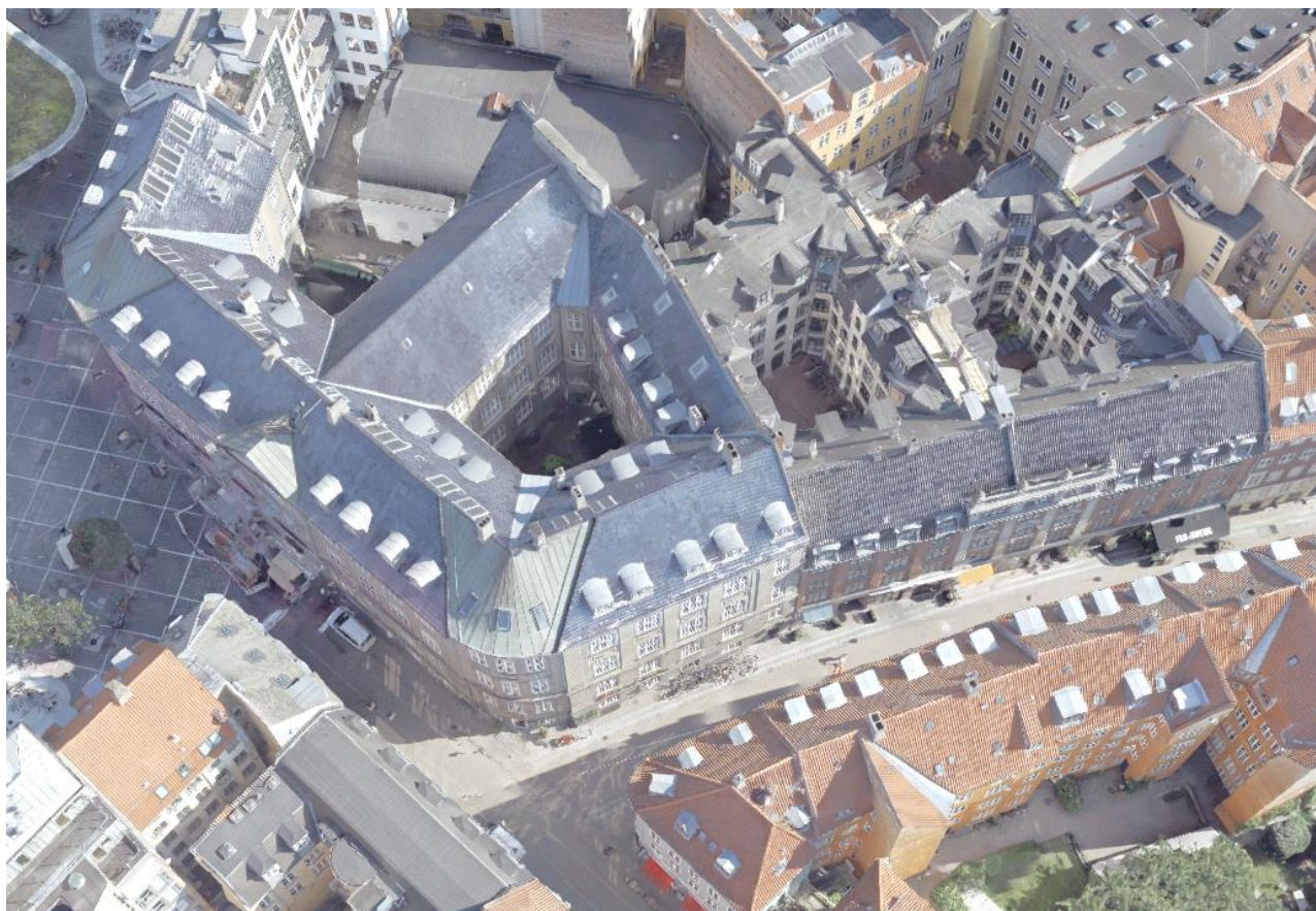
Abb. 5: Ausschnitt aus einem 3D-Mesh der Stadt Kopenhagen von 2021 (GSD der Luftbilder: 2,5 cm)
